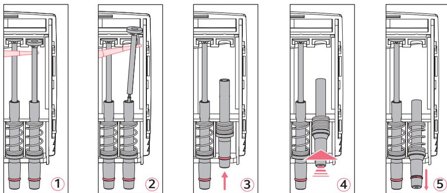
1. ① и ②: приложите наконечник для дозатора под поршень и осторожно отделите поршень от верхней направляющей.
