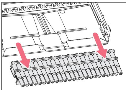
2. Вытолкните блок цилиндров параллельно вниз из оболочки корпуса.
