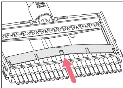
1. Поднимите клеммную панель посередине и снимите ее.
