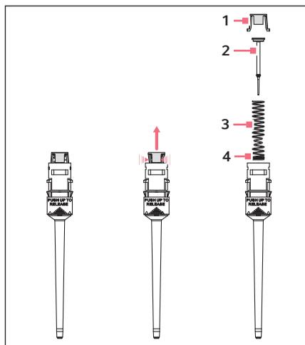
1. Слегка сдавите фиксирующие защелки на держателе поршня (1).
