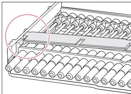
3. Вставьте клеммную панель с одной стороны под переднюю часть в оболочку корпуса.
