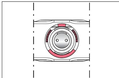
3. Рассмотрите отделенную нижнюю часть сверху. Для этого отодвиньте оболочку корпуса вниз. Точно запомните положение обозначенных красным цветом частей. **Обозначенные красным цветом упоры на оболочке корпуса и обозначенные красным цветом зубцы на внутренней части расположены вблизи друг от друга.** Если после сборки упоры и зубцы расположены друг на друге, оболочка корпуса была установлена неправильно.
