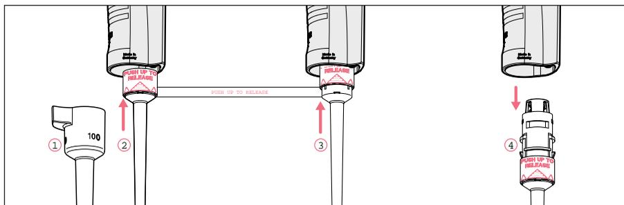
1. Удерживая сбрасыватель в нажатом состоянии, снимите втулку сбрасывателя ①.
