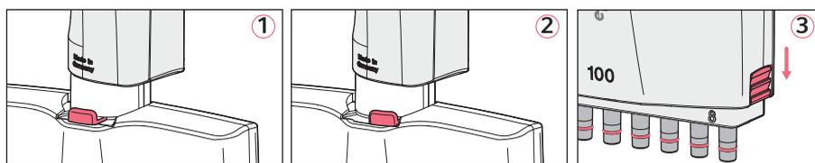
1. ① и ②: сдвиньте рычаг на нижней части влево или вправо. Потяните нижнюю часть вниз, чтобы деактивировать магнитное соединение нижней части. При этом нижняя часть отделится от верхней, и ее можно будет снять.
